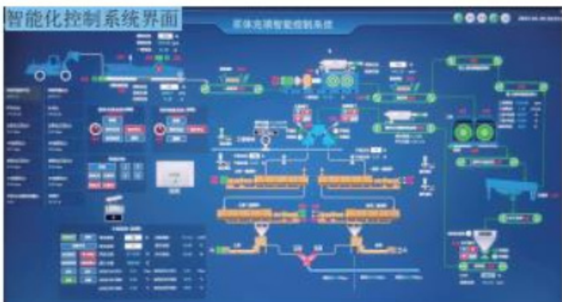
Hình 11 Hệ thống điều khiển thông minh chèn lò bằng vữa
